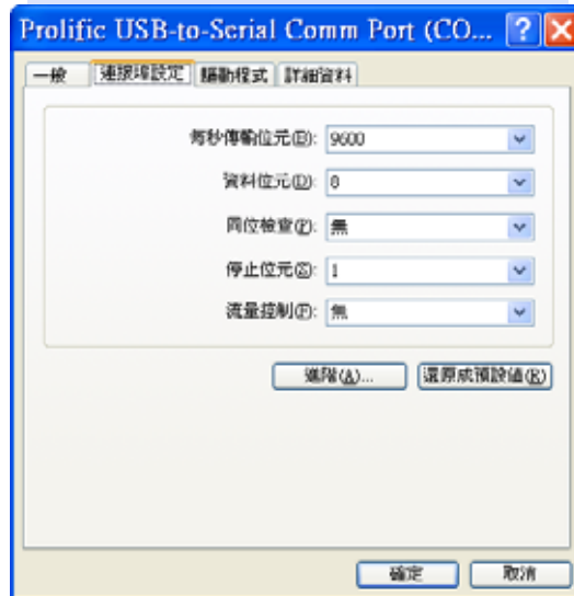
圖三、COM PORT 的 Baud Rate 設定值。 (Auto-ISP 不需設定 Baud Rate)
