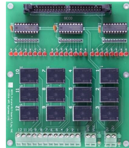
12-ch 三態切換器模組 Model: WPC-12-3S-SW Relay power 12VDC VCC/GND/NC 三態切換
