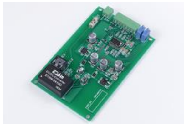
LVDT 放大器 Model: LVDT-300
